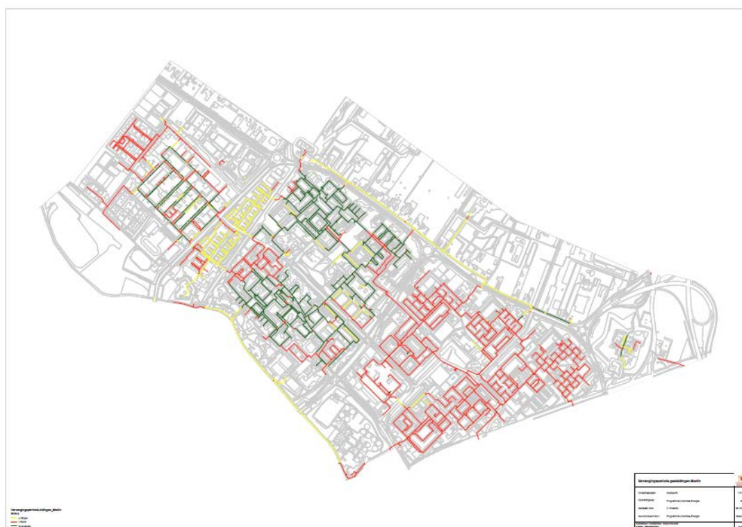
Figuur 17– gasvervangingskaart Overvecht-Noord (groen en geel: te vervangen, rood: reeds vervangen), bron: Stedin
