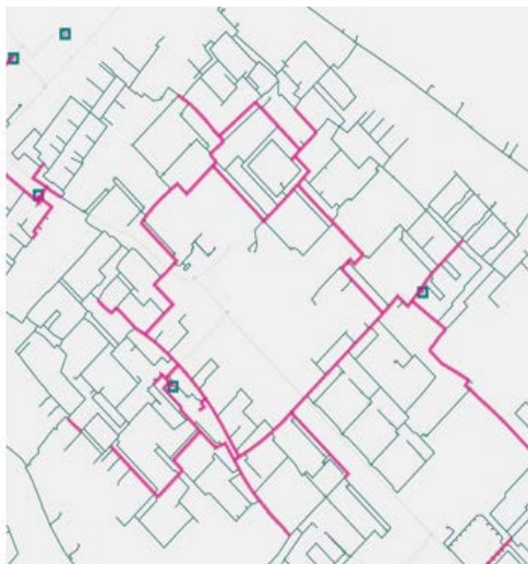
Figuur 18– hoofdstructuur gasleidingen Overvecht-Noord (roze), bron: Stedin
